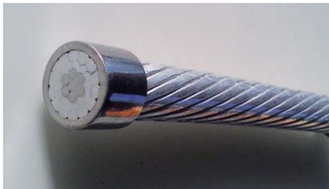
Рис. 2. Модель нового компактированного провода (три проводящих слоя, сердечник)
