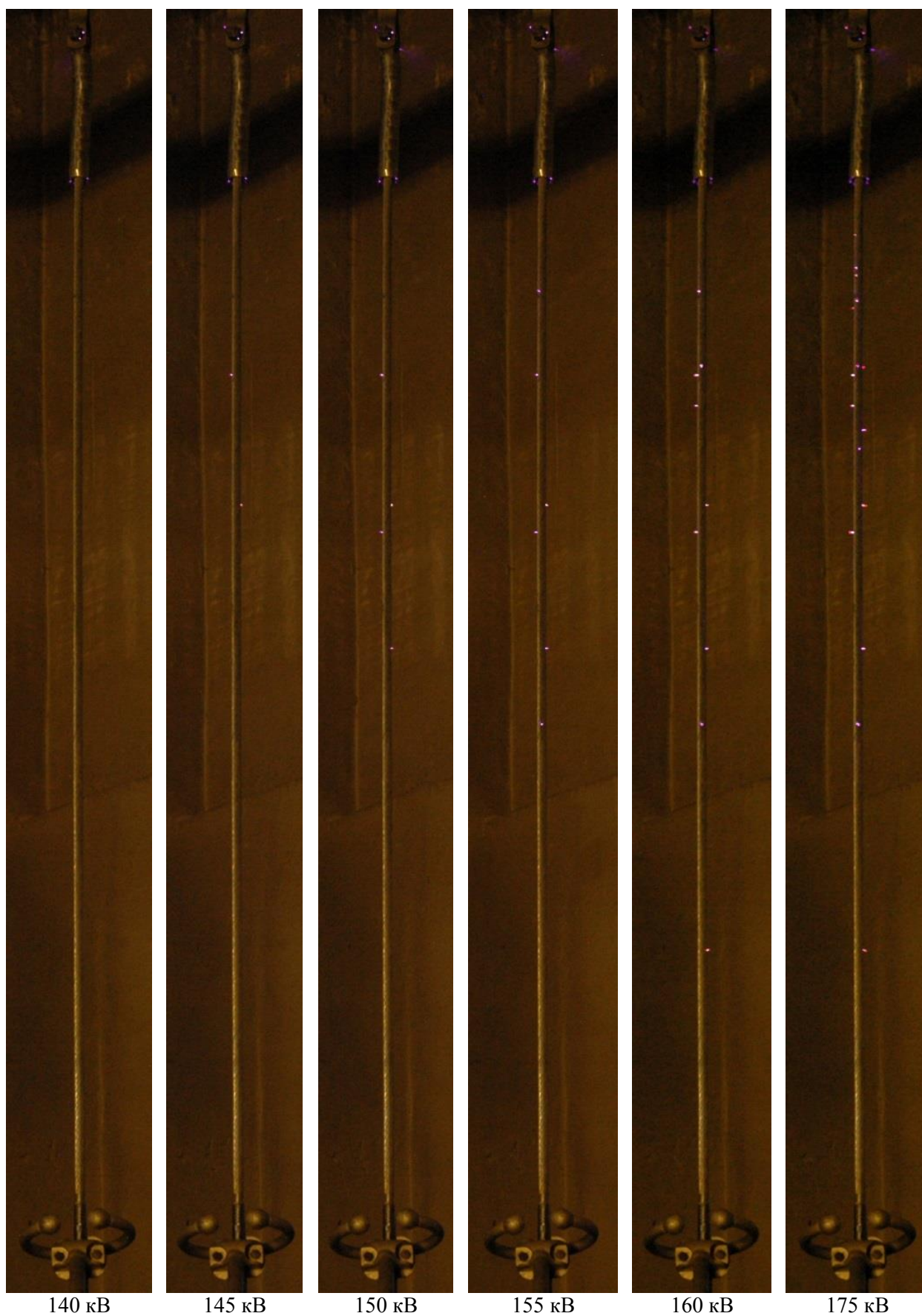
Рис. 7 – Коронный разряд на проводе АСВП 197/55 при различных напряжениях
