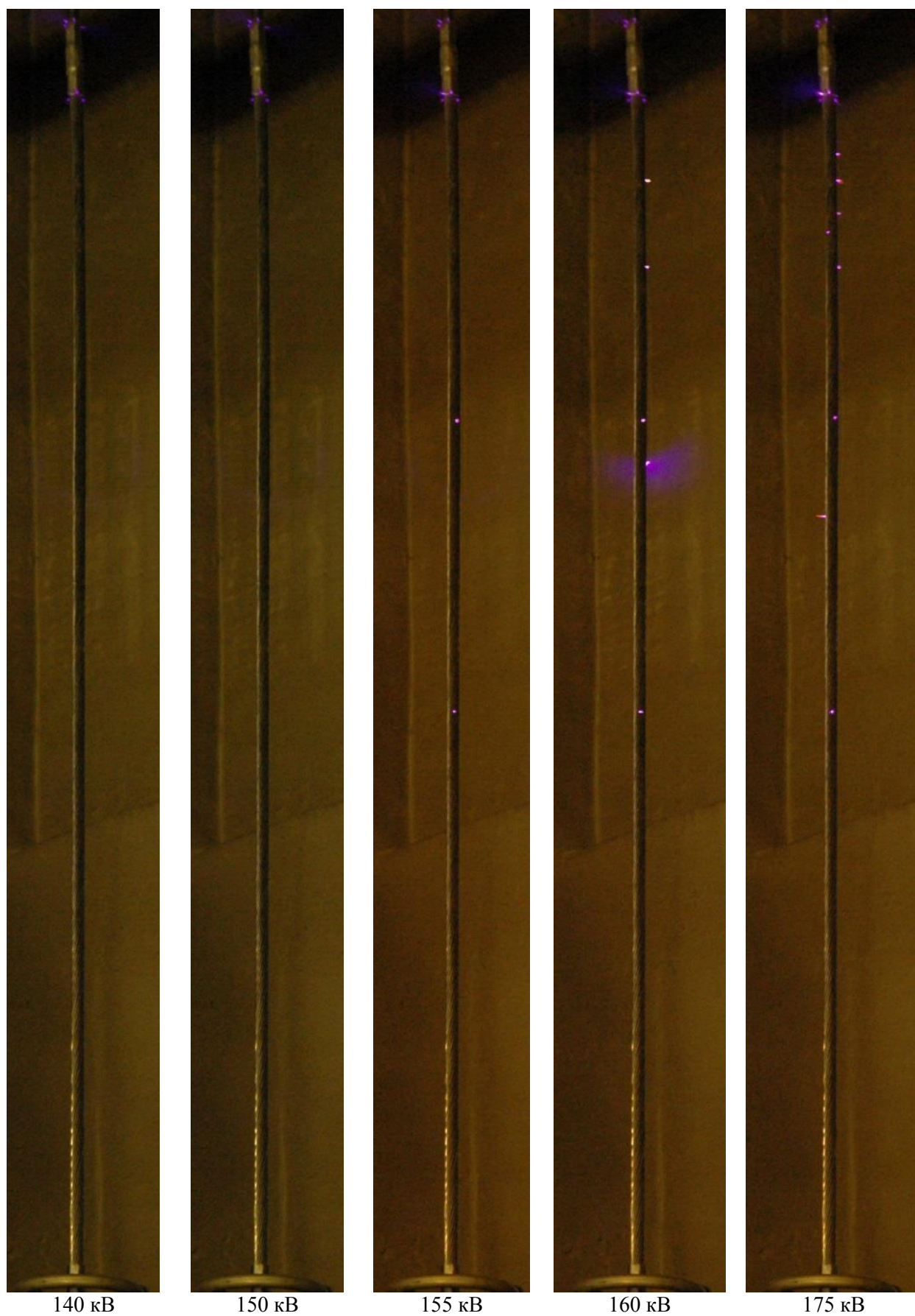
Рис. 6 – Коронный разряд на проводе АС 240/32 при различных напряжениях
