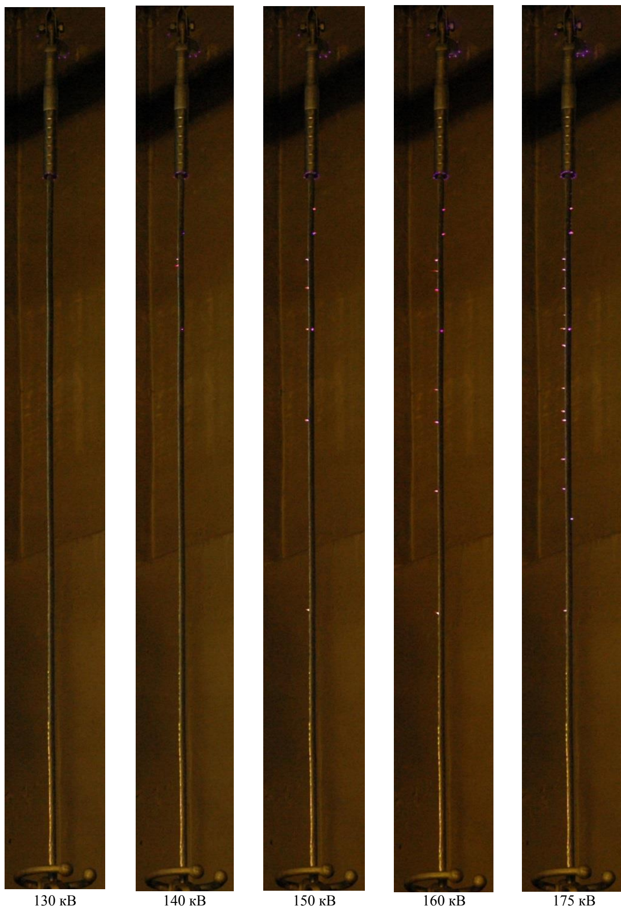
Рис. 5 – Коронный разряд на проводе АС 185/29 при различных напряжениях
