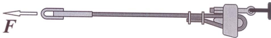
Рисунок 2 – Схема испытаний на прочность заделки в натяжных зажимах (НС-140-3 слева и ЗК-1-1.Ч справа).
