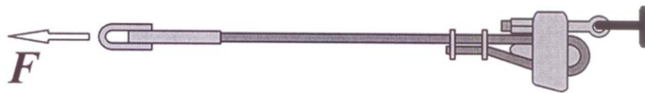
Рисунок 2 – Схема испытаний на прочность заделки в натяжных зажимах (НС-70-МЗ слева и ЗК-1-1.Ч справа).
