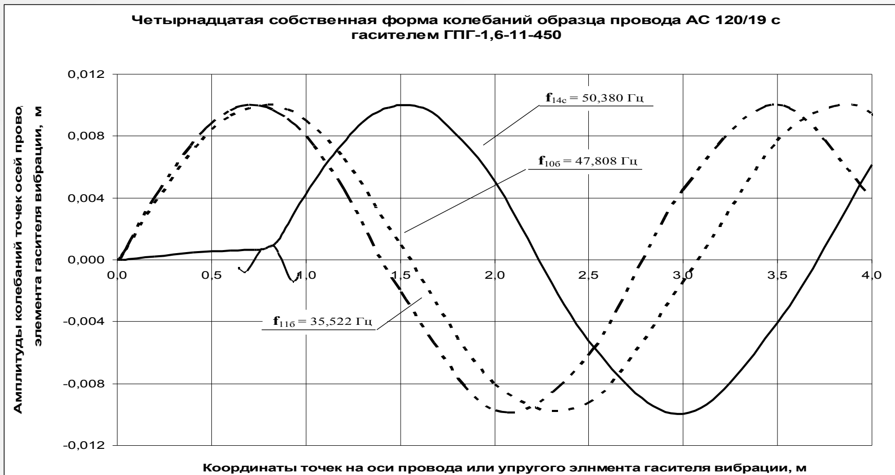
Рис. 17. Амплитуды колебаний провода АС 120/19 с гасителем вибрации типа ГПГ-1,6-11-450 (четырнадцатая собственная форма колебаний)
