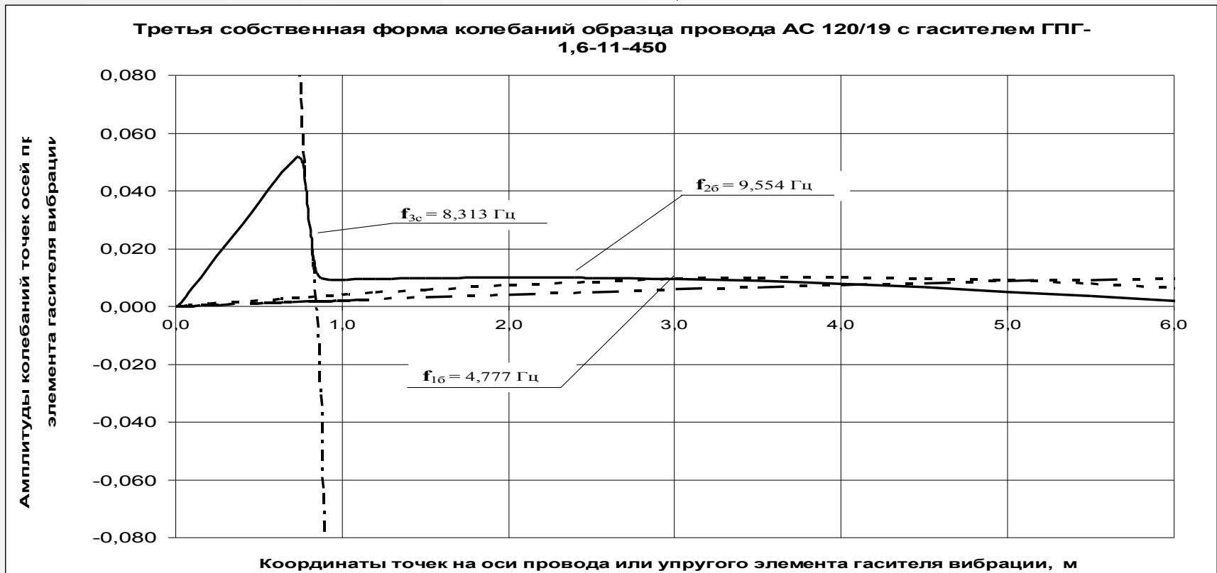
Рис. 9. Амплитуды колебаний провода АС 120/19 с гасителем вибрации типа ГПГ-1,6-11-450 (третья собственная форма колебаний)
