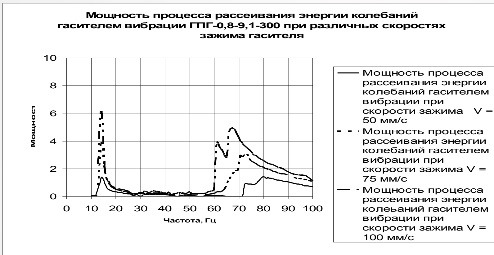
Рис. 6. График мощности процесса рассеивания энергии колебаний гасителем вибрации ГПГ-0,8-9,1-300
